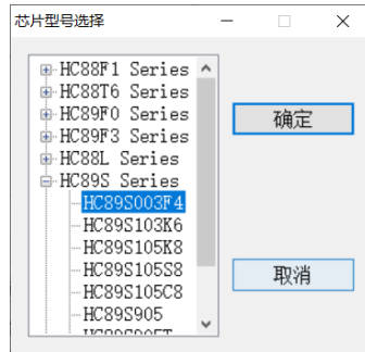
圖 4.1-2 晶片型號選擇對話方塊，選擇晶片型號後點擊“確定”按鈕退出
