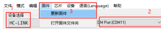
圖 8-1 設備選擇 HC-LINK，埠選擇正確的設備埠，點擊功能表列“固件”、“更新固件”
