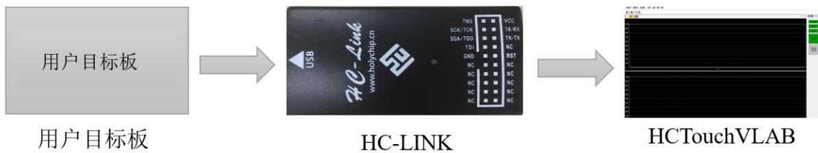
图2-1 HC-LINK硬件连接
