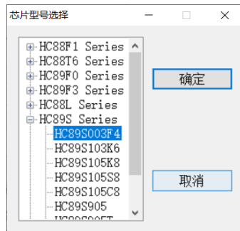
图 4.1-2 芯片型号选择对话框，选择芯片型号后点击“确定”按钮退出
