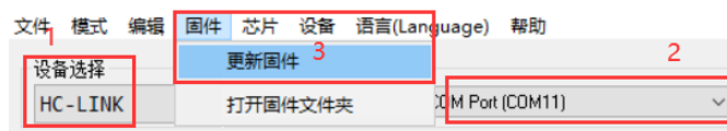
图 8-1 设备选择 HC-LINK，端口选择正确的设备端口，点击菜单栏“固件”、“更新固件”
