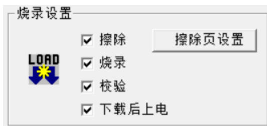
图 7.9-1 烧录设置 配置是否“擦除”、“烧录”、“校验”、“下载后上电” 擦除可以设置“全擦”/“按页擦除”
