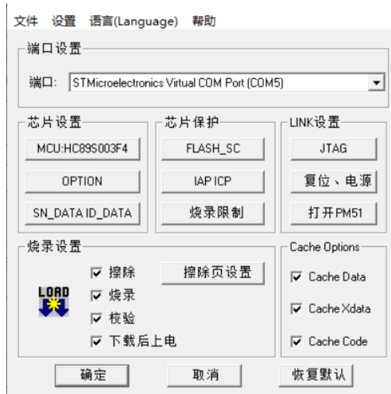
图 2-11 HC-LINK 插件运行成功窗口，点击“打开 PM51”按钮
