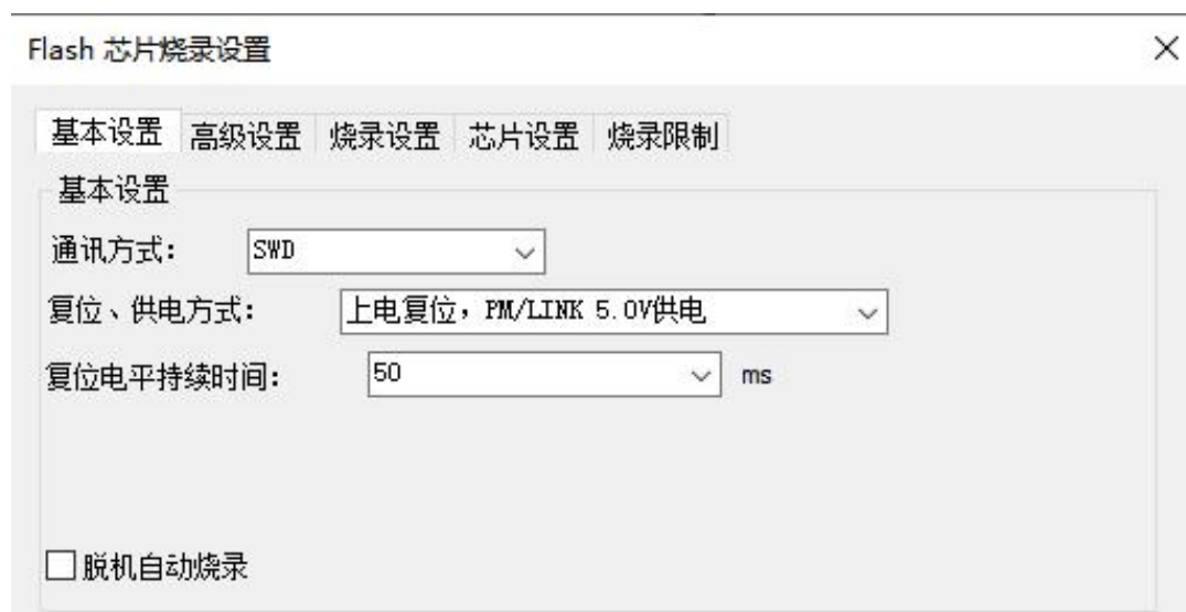
图 4.1.1.1-1 研发模式下 FLASH 芯片基本设置界面
