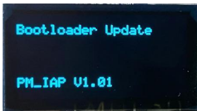
图 6.2-1HC-Programmer 烧录器屏幕显示
