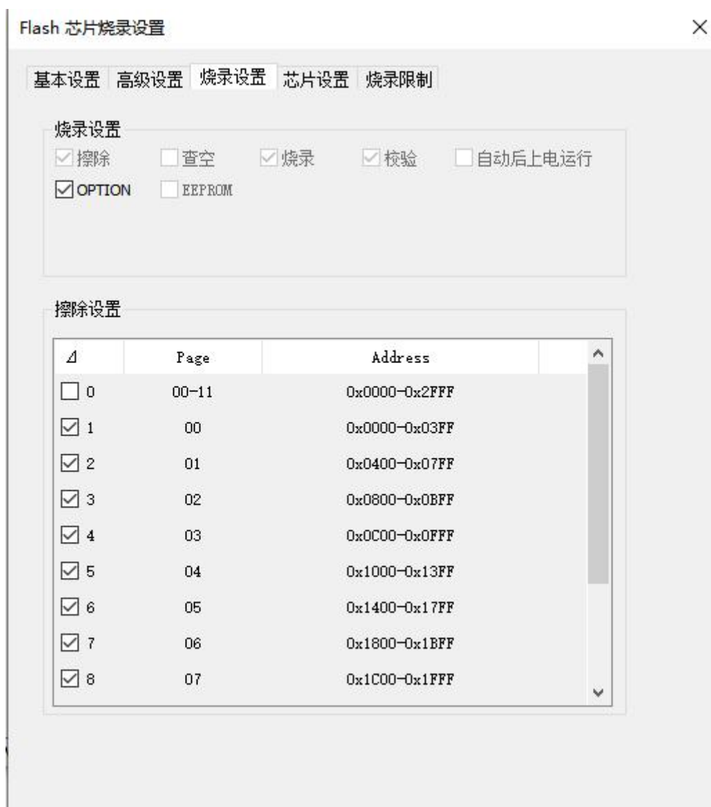
图 4.1.2.3-1 ISP 模式下 FLASH 芯片烧录设置界面
