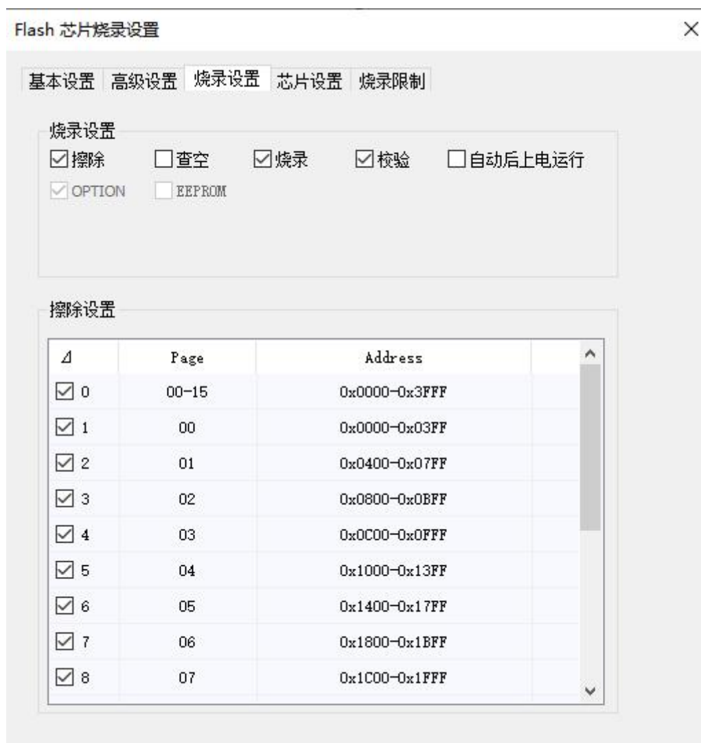
图 4.1.1.3-1 研发模式下 FLASH 芯片烧录设置界面
