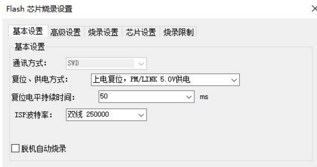
图 4.1.2.1-1 ISP 模式下 FLASH 芯片基本设置界面
