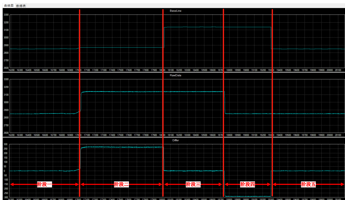
图 12-4 自动复位和低基准线复位
