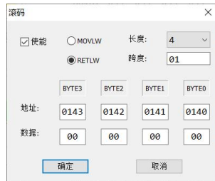
图 4.4-2 滚码配置对话框，配置“使能”、“MOVLW”、“RETLW”、长度、跨度、地址、数据
