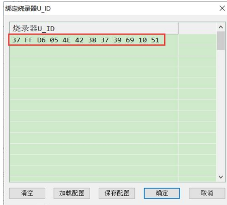
图 4.6-5 “绑定烧录器 U_ID” 设置对话框，设置后烧录文件只允许下载至指定烧录器（设置前连接 HC-PM18-V5，进入设置对话框后会自动读取并填写好 U_ID）
