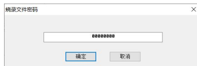
图 4.6-2 “烧录文件密码”设置对话框，设置密码后，再次加载此烧录文件切换至研发模式时需要此密码
