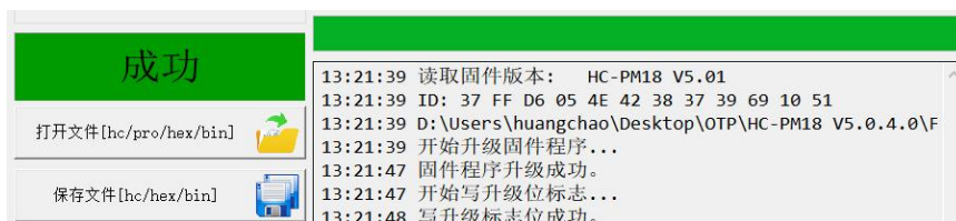
图 5-3 固件更新成功，请耐心等待 HC-PM18 PRO-V5 硬件复位，蜂鸣器“滴”一声后烧录器固件更新成功
