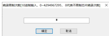
图 4.5-3 “烧录限制次数”设置对话框，设置后手动烧录/机台烧录会限制烧录次数
