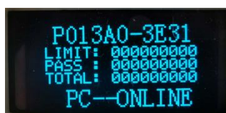
图 3.2-5 HC-PM18 PRO-V5 显示屏确认芯片型号及芯片特征码
