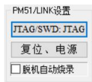
图 4.4-1 PM51/LINK 设置，JTAG/SWD 通讯方式选择按钮
