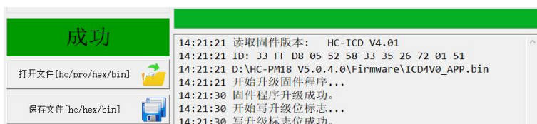
图 9.2-4 固件更新成功，HC-ICD-V4 LED 灯先灭后亮
