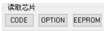
图 4.11-1 读取芯片 CODE、OPTION、EEPROM，芯片设置读保护后，读 CODE 数据窗口显示全 0
